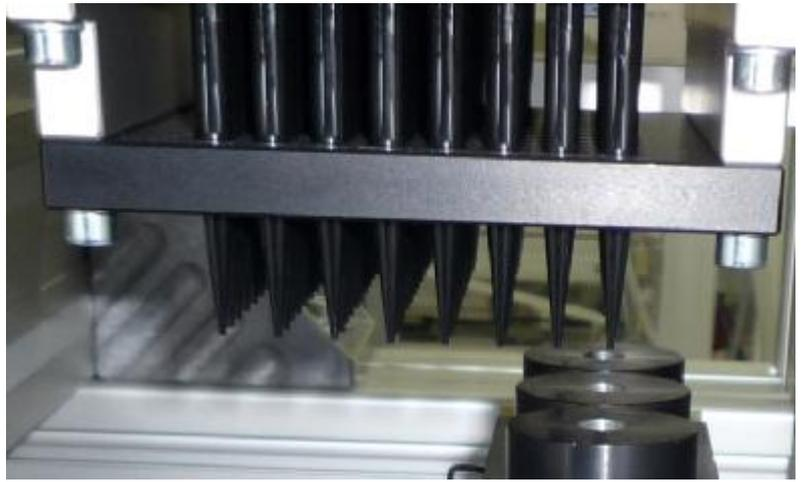
Das Kontrollsystem QMTSort-PlastInject ist in die Entlade- und Konditionieranlage integriert. Dies erlaubt eine lückenlose Kontrolle und unverzüglicher Korrektur im Falle von Abweichungen des Spritzgussprozesses. Die Pipetten werden im Kundenrack geprüft. Damit ist sichergestellt, dass keine zusätzlichen Beschädigungen beim weiteren Handling auftreten.
